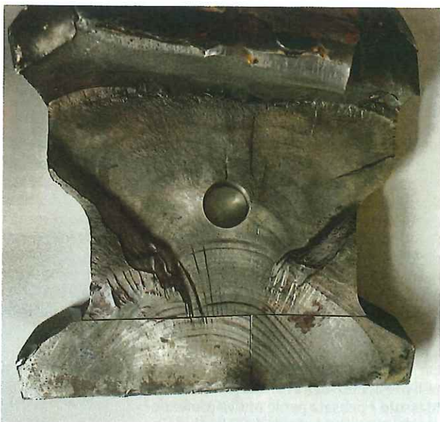
I cosiddetti "beach marks" sulla superficie di una lesione di fatica di un componente di macchina
