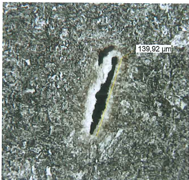
Difetto interno del materiale e possibile punto di innesco della frattura per concentrazione delle tensioni su una cuspid
