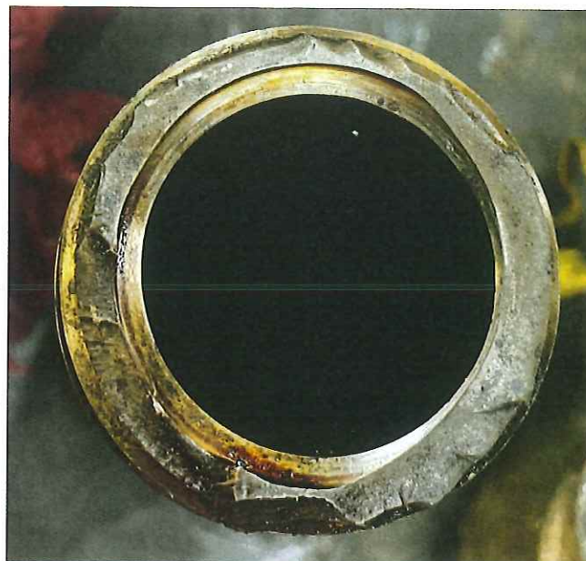
Rottura di fatica in corrispondenza del primo filetto di un raccordo di un componente di macchina
