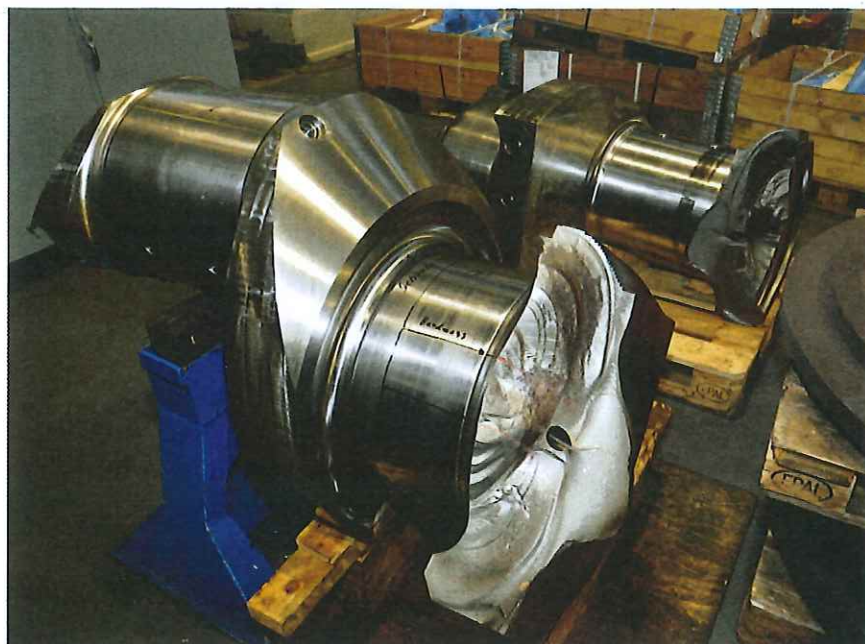
La frattura di fatica su una maschetta di un albero a manovelle (diametro del perno di piede di Biella 415 mm)
