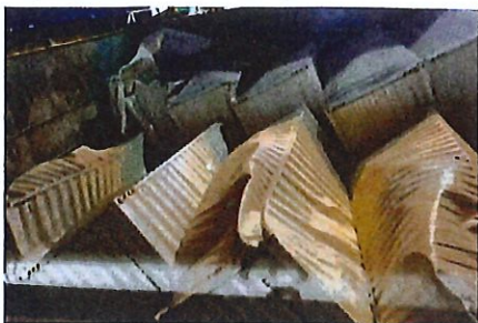
Da sinistra - Effetti di un rizzaggio errato in stiva, imbarco containers su una nave bulker e Teus stivati correttamente (box shaped) in una nave da carico
