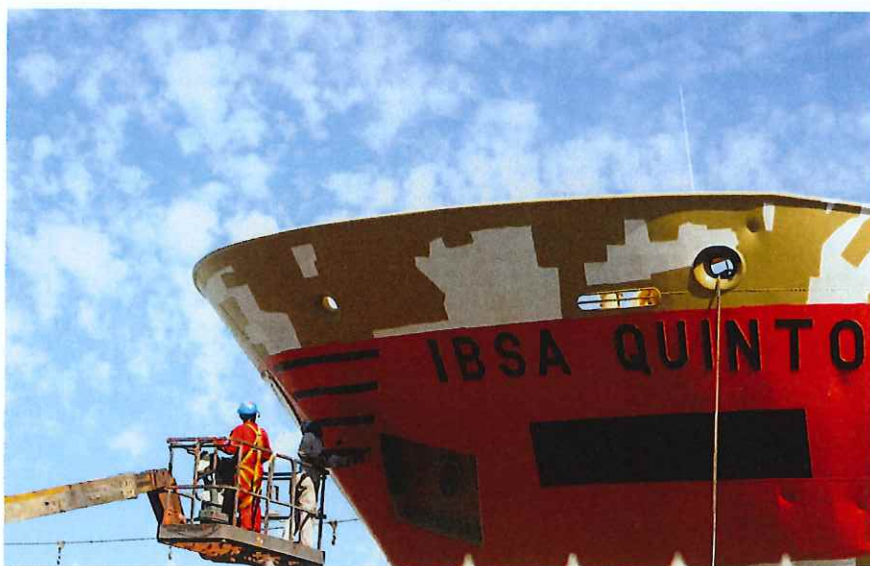
Intervento di verniciatura su una nave in cantiere
